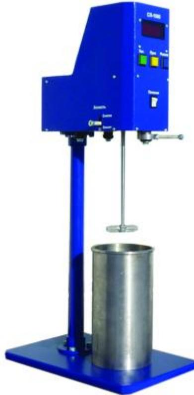
Смеситель тампонажного раствора лабораторный (лопастной) СЛ-1500 предназначен для размешивания цементных (по ГОСТ 26798.1-96) и других растворов в лабораторных условиях при приготовлении испытательных образцов.
